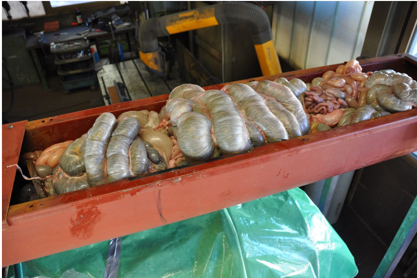
Zuführung über Spirale mit 5.8 U/min zu Separator
