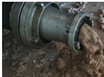
Substrat aus dem Hybag-Separator bei 50 Hz mit 1'480 U/min.
